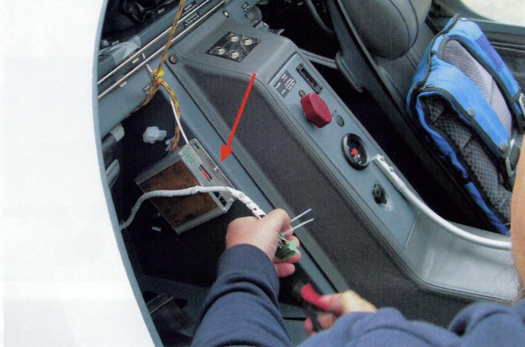
Der KAPI-Datenlogger wird hier gerade fest in einen Motorsegler Stemme S-10 eingebaut.
