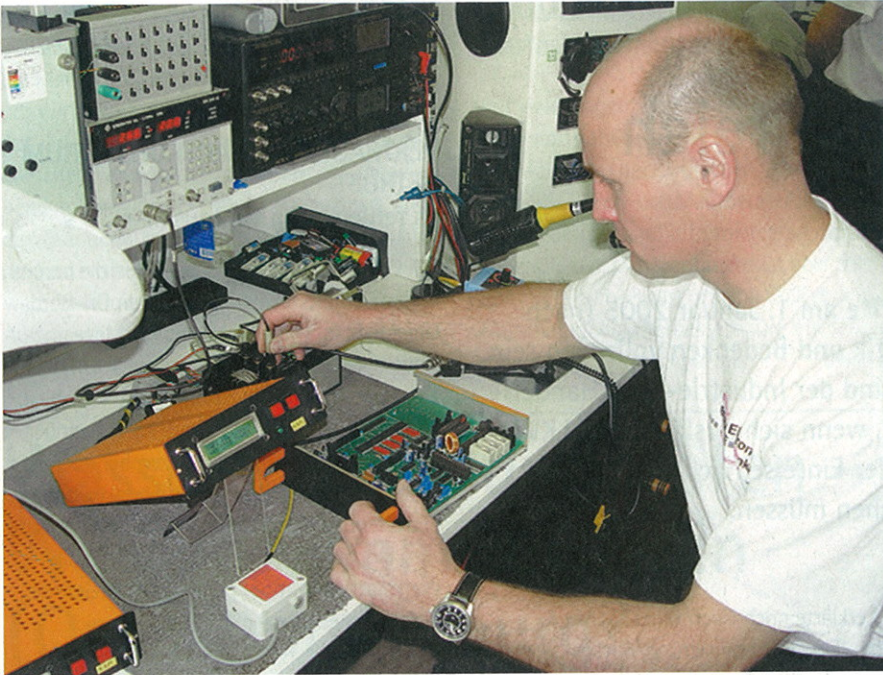
Holger Kalinka während seiner Arbeit am KAPI, dem Datensreiber für kleine Luftfahrzeuge.
