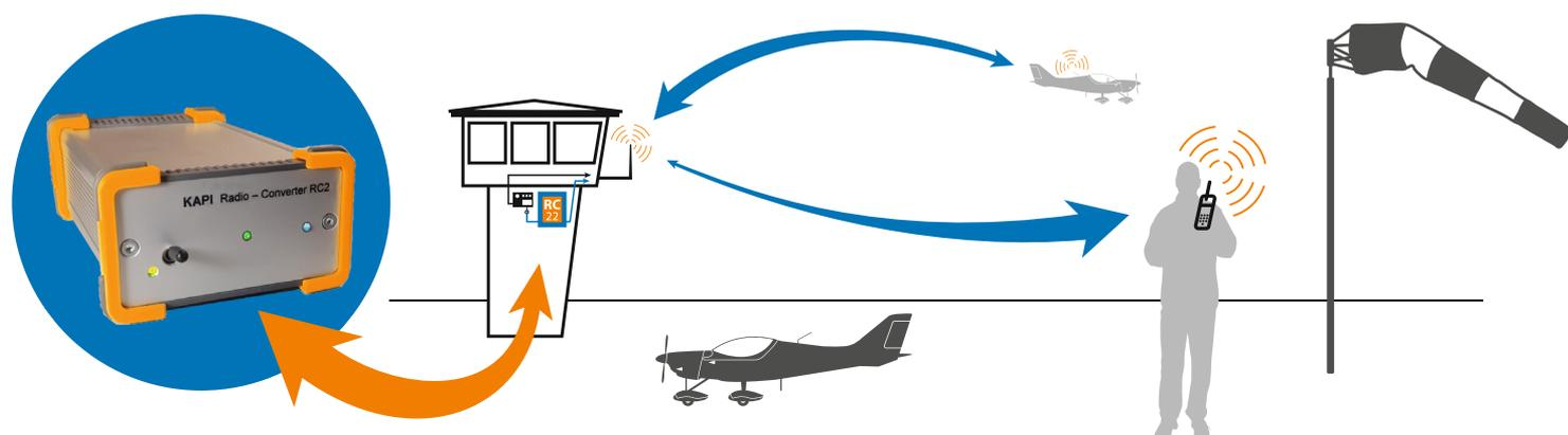
Flugplätze unterliegen einer ständigen Hörbereitschaft. Um einen Flugleiter nicht immer im Tower zu binden, ist eine Flugfunkreichweitenerhöhung durch Frequenzwechsel auf eine Betriebsfunkfrequenz von Vorteil, um auch außerhalb des Towers mit einer größeren Reichweite am Flugplatz flexibel und mobil zu bleiben.
